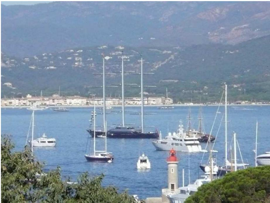
Vorsichtig umrunden wir sie auf eigenem Kiel und lassen uns einige Maße auf der Zunge zergehen: Länge 88 Meter, Breite 12,50 Meter, Tiefgang sechs Meter, Verdrängung 1.240 Tonnen, Masthöhe 58 Meter über Wasser, Segelfläche 2.400 Quadratmeter. Kraftstofftank 100.000 Liter. Reisegeschwindigkeit unter Motor 19,5 Knoten, Werft Perini in der Türkei.
