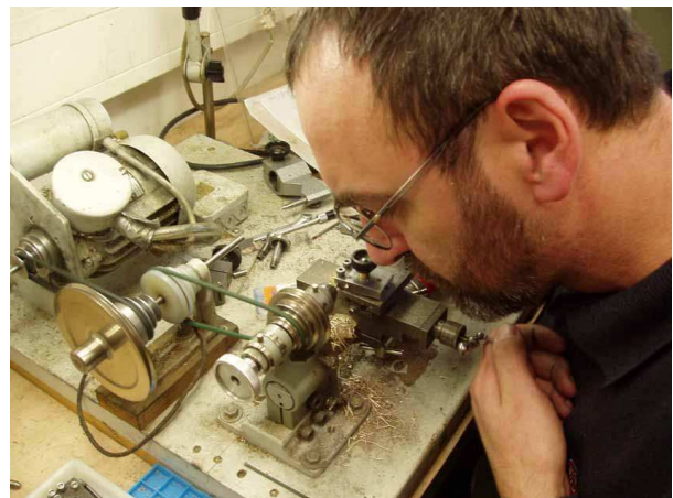
Abb. 5 Uhrmacher Klaus Kontzog fertigt auf einer alten Drehbank ein Werkzeug an.
