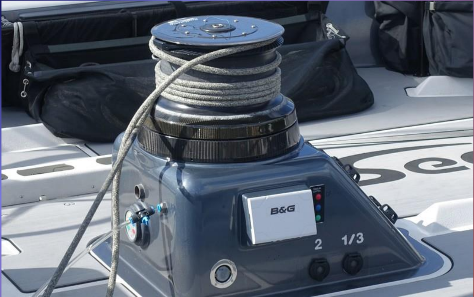
Elektrische Winsch auf dem Volvo-Ocean-Racer Scallywag (Bj. 2017). Kurbeln nur noch bei Stromausfall.
