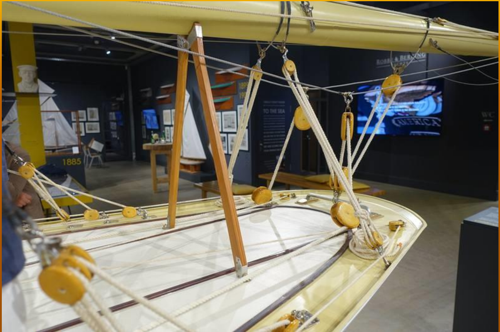
Die Schotführung wurde auf dem Modell naturgetreu nachgebaut.
