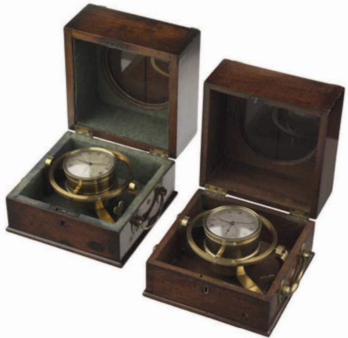
Abb. 37 Schiffschronometer von Thomas Earnshaw
