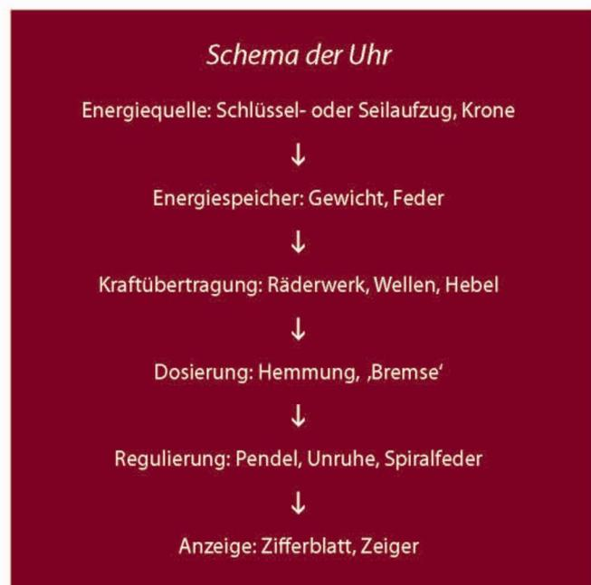
Abb. 22 Schema der Uhr
