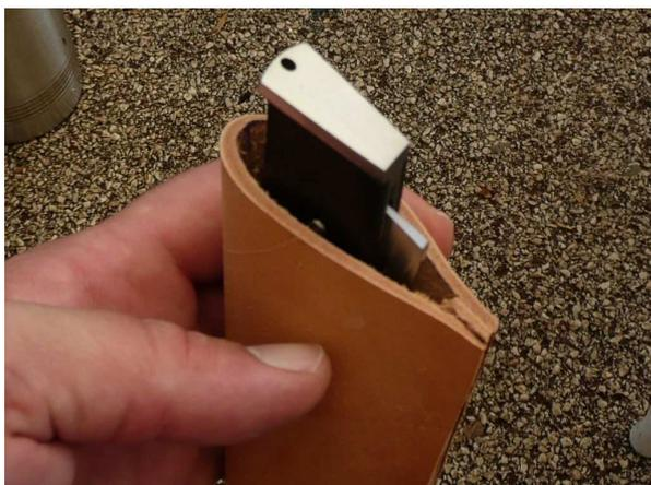
Wieder die Naht mit der Gabel vorzeichnen und mit der Ahle nachstechen. Das Dreifach-Paket ist nicht so ganz dünn, aber es ging mit der Ahle so gerade noch. Bei dickerem oder festerem Leder sollte man vorbohren, entweder mit 1 oder 1,5 mm mit dem Bohrständler, oder von Hand mit einem Dremel.
