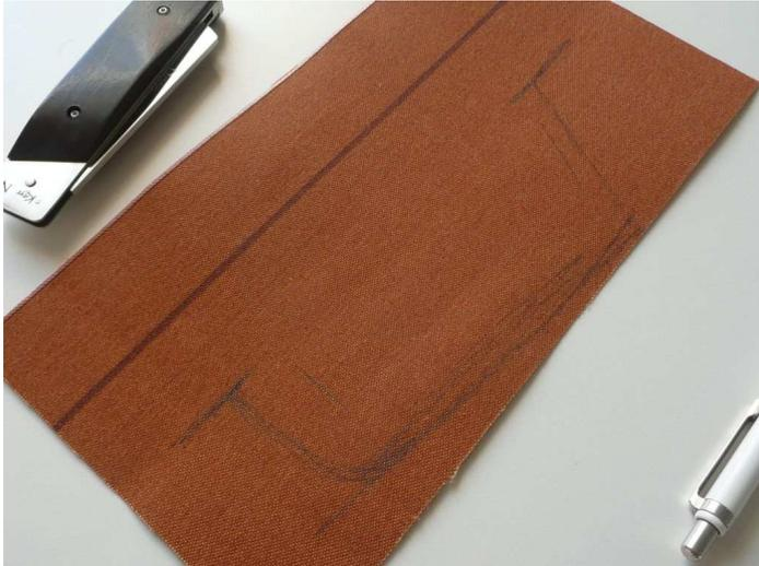
Zunächst wird auf einem Stück Segeltuch die Form des Messers nachgezeichnet und ein wenig Reserve rechts und links gelassen. Man schneidet zunächst nur eine Hälfte zu und klappt diese dann einmal um, so
