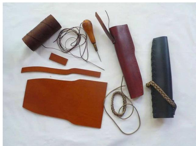
Inzwischen hat Yves Pierrat auch die Herstellung der Lederscheiden übernommen - auch das eine knifflige Arbeit, die viel Erfahrung und Fingerspitzengefühl bei der Verarbeitung des Leders und beim Zusammennähen erfordert. Charakteristisch ist die Art der Gürtelhalterung, die diagonal und an der Außenseite der Scheide verläuft. So hängt das Messer zwar ein wenig schief, ist dafür aber immer griffbereit.
