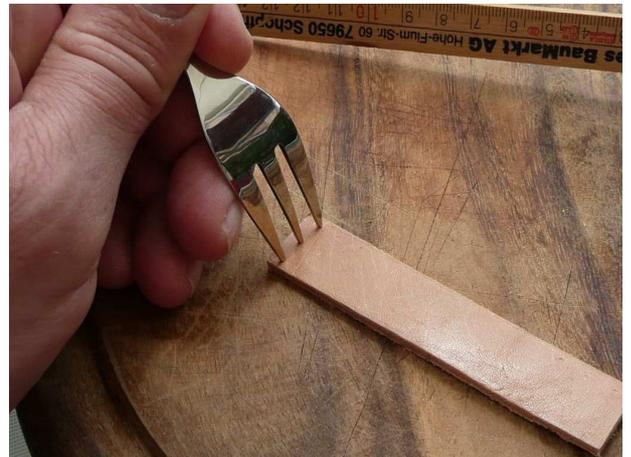
Die Ahle hat einen Durchmesser von knapp 2 mm, die Löcher sind so für die sog. Schusternaht sehr angenehm zu durchstoßen, ggf. reichten aber Löcher mit 1,5 mm auch aus. Ich habe einen roten
