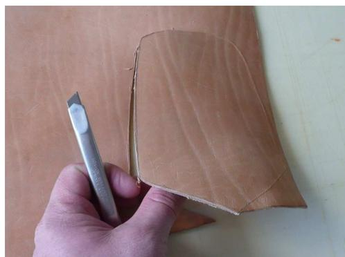
Ist der Entwurf des Zuschnitts einigermaßen gelungen, wird das Stück ausgeschnitten, und die Konturen werden auf das Leder übertragen und dieses zugeschnitten. Als Leder habe ich ein Stück pflanzlich gegerbtes Rindsleder verwendet, die Dicke ist 3-4 mm, das reicht für Lederscheiden aus. Verschieden große Stücke sind gut zum Beispiel beim [Lederversand-Berlin.de](http://Lederversand-Berlin.de) zu beziehen.
